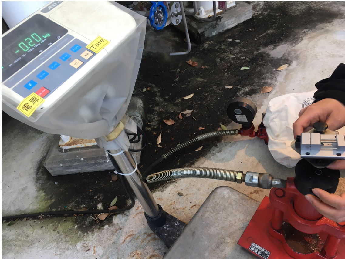
図3：荷重圧縮を解いた試験後、MgF2 試料を確認している様子。試料の破損が無い事が確認された。
