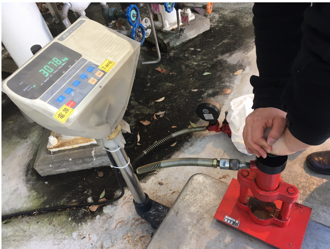
図2 : MgF2 板に、 \phi 1.90\text{mm} の圧力端子を介して、荷重を左右させた際の様子。計測計の数値は 30.78kg を示しており、今回の基準値である 21.2kgf（安全率 1.2 を考慮して 25.44kg）を十分に超える荷重圧縮に耐える強度を有する事が確かめられた。
