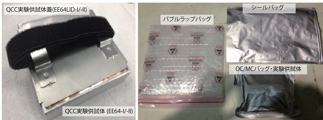
図3：実験供試験体(左図)および実際の打ち上げ／回収のための輸送時の梱包構成(右図)
