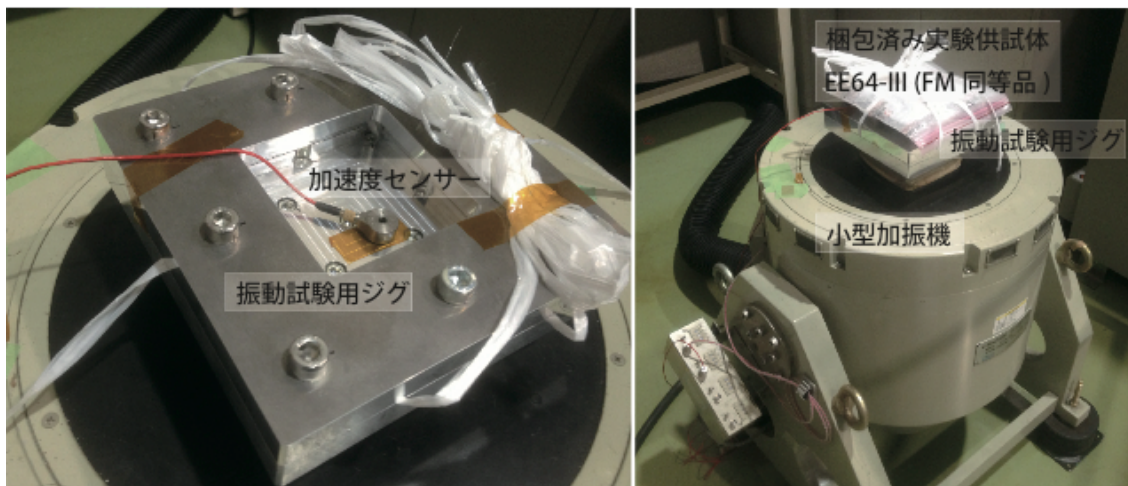
図4：小型振動試験機にジグを取り付けた状態（左図：ジグ加振実験時の様子）および実際の打ち上げ/回収輸送時の梱包構成をした実験供試体(EE64-III)のFM同等品の振動試験用ジグへの設置の様子。（右図：梱包済み実験供試体EE64-IIIのFM同等品に対して実施したAT振動試験実施時の様子）
