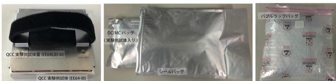
図3：実験供試体(左図)および実際の打ち上げ/回収のための輸送時の梱包構成(右図)
