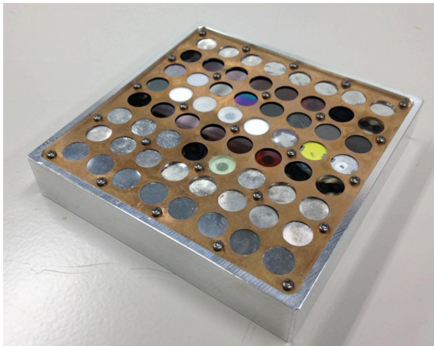
図4.3.3：試料ホルダー台、試料ホルダー、リン青銅板バネの試作モデル(PM)に試料(テストピース)をインストールして組み立てた様子の写真。
