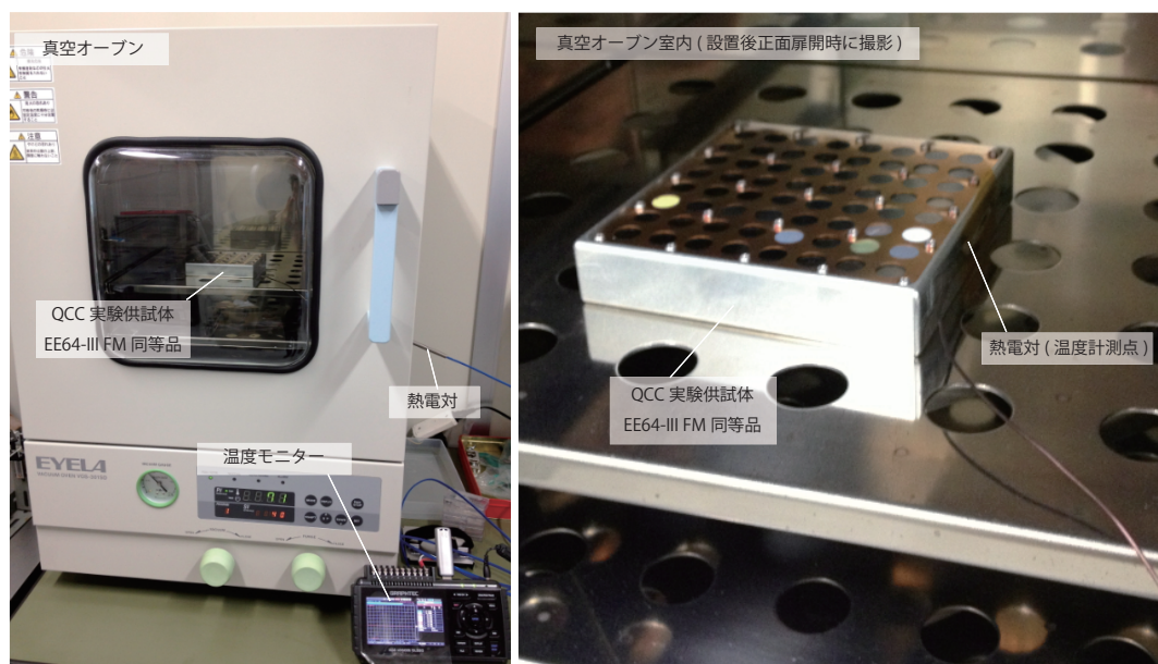
図1：真空高温晒し試験で用いた真空恒温槽EYELA真空オーブンVOS-301SD(左図)と真空オーブン室内にQCC実験供試体EE64-IIIの試料ホルダー外枠に熱電対を接触させた状態で設置する様子(右図)。
