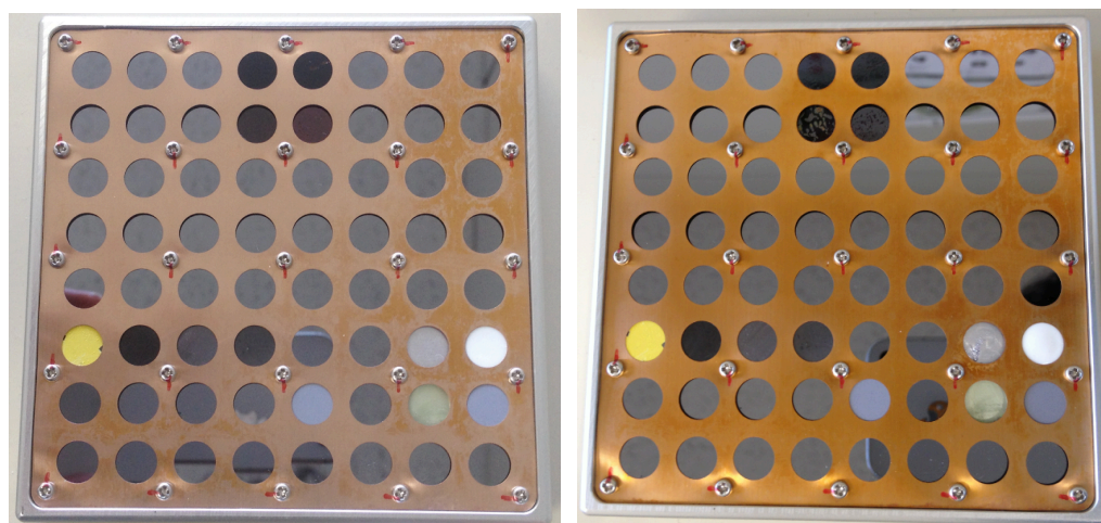
図3：高温晒し試験実行前のQCC実験供試体EE64-IIIの様子(左図)および試験後取り出した実験供試体EE64-IIIの様子(右図)。
