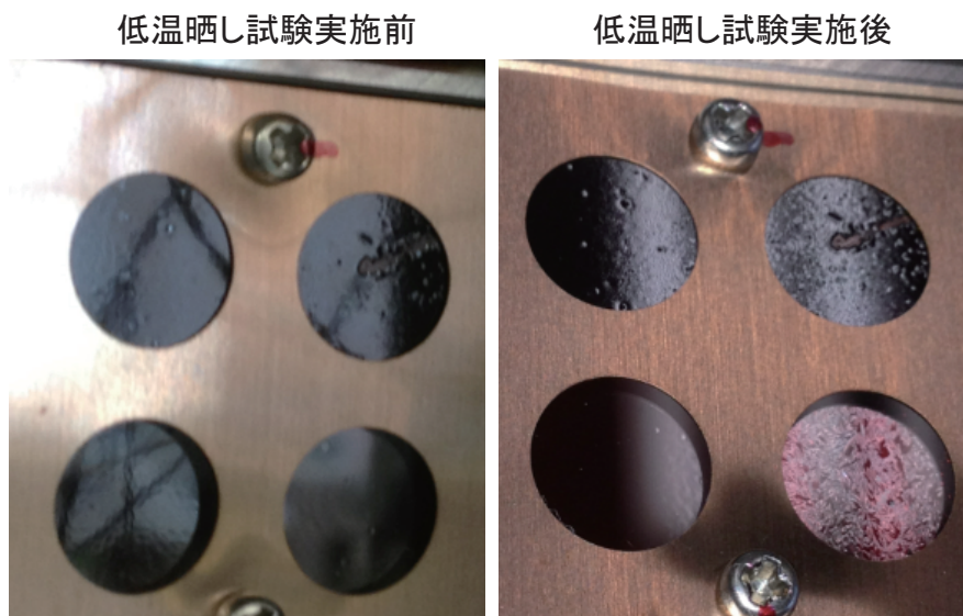
図5：低温晒し試験実施前（左）及び、試験後（右）の各種条件（厚み、基板研磨状態）で堆積させた QCC 堆積試料の詳細画像。
