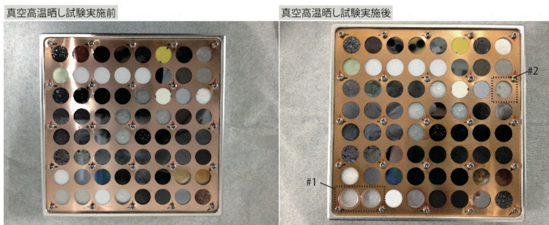
図3：高温晒し試験実行前のQCC実験供試体の様子(左図)および試験後取り出した実験供試体の様子(右図)。
