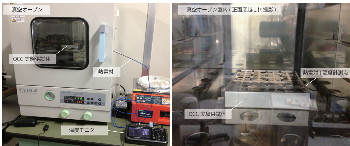
図 1：真空高温晒し試験で用いた真空恒温槽 EYELA 真空オープン VOS-301SD (左図) と真空オープン室内に QCC 実験供試体ホルダーに熱電対を接触させた状態で設置する様子 (右図)。
